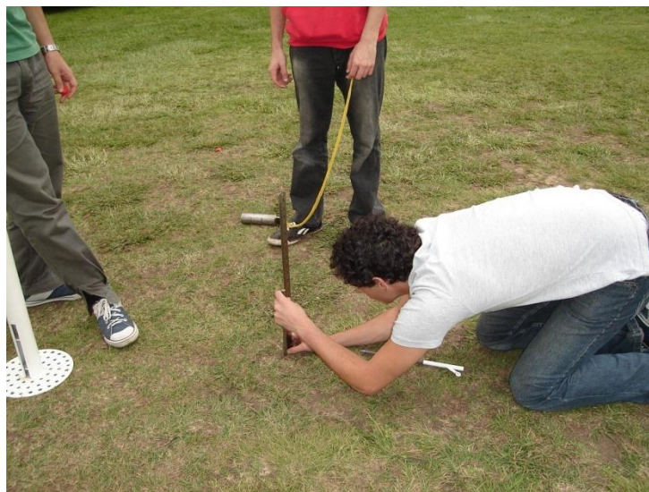
Medición de la profundidad alcanzada por el penetrómetro.
